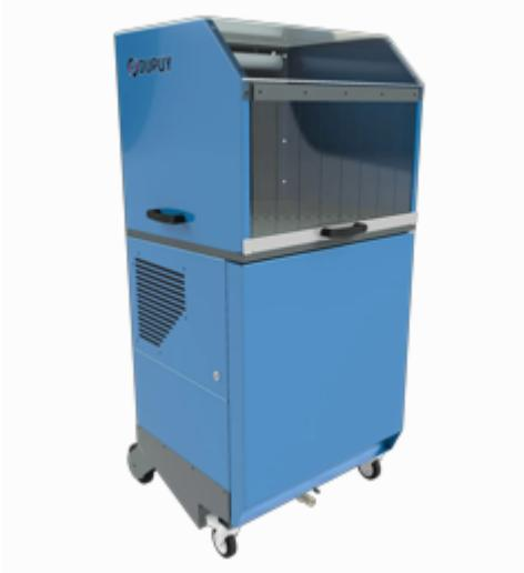
Adatto per la pulizia post-lavorazione di pezzi da lubrorefrigeranti e trucioli metallici.
